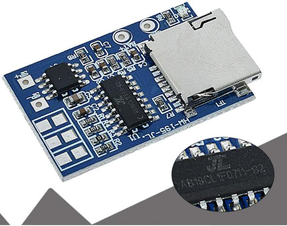
Tension de fonctionnement: batterie au Lithium 3.7V 600MA ou alimentation USB 5V
